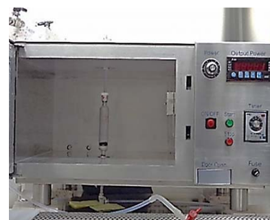
圖2. 本研究所採用之微波觸媒反應器
