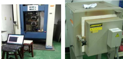
圖 2. 萬能拉伸試驗機及加熱爐
