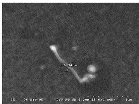
圖 3. 奈米碳管 SEM (前處理溫度  $800^\circ\text{C}$ )
