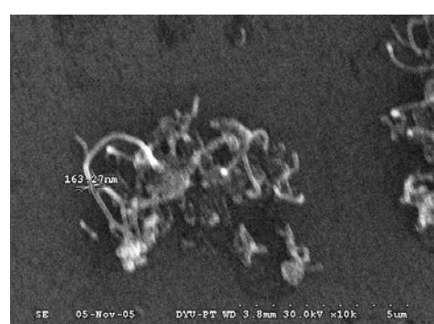
圖 4. 奈米碳管 SEM (前處理溫度 900°C)
