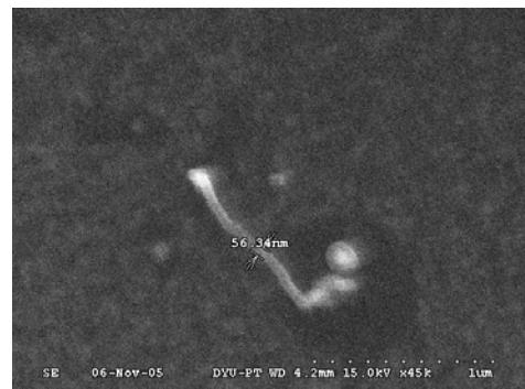
圖 3. 奈米碳管 SEM (前處理溫度 800°C)
