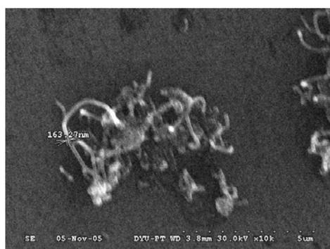
圖 4. 奈米碳管 SEM (前處理溫度  $900^\circ\text{C}$ )
