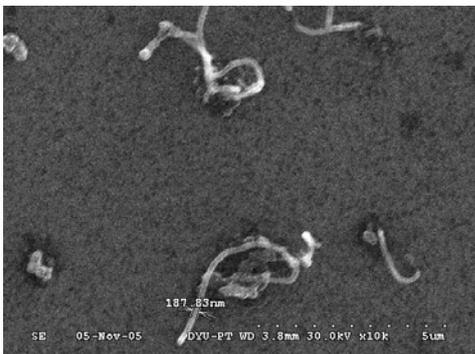
圖 5. 奈米碳管 SEM 圖 (通氫氣)
